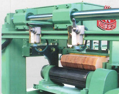
鉋刃ブロック加工
